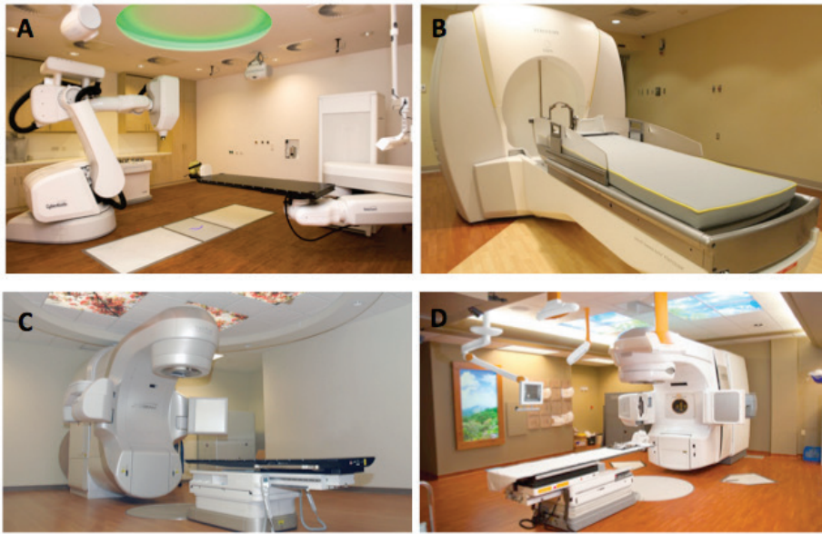
Gambar 2. Gambar berbagai pesawat radiasi pada radiosurgery (A) CyberKnife ® ; (B) Gamma Knife ® ; (C) LINAC; (D) Novalis ® LINAC dikhususkan untuk radiosurgery
