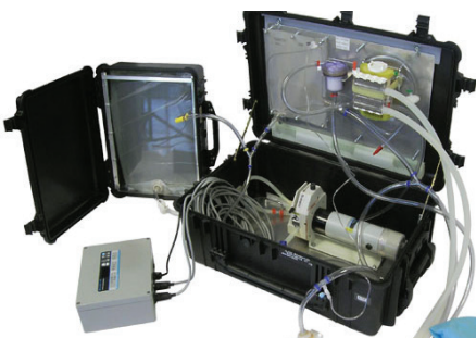
Gambar 1. Alcor's Air Transportable Perfusion kit (ATP). Alat untuk menjaga pasien agar selnya dapat tetap hidup pada saat ditransportasikan ke pusat cryonic . 8
